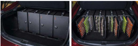
Vier Schlüsselschränke mit insgesamt 596 Befestigungen für Schlüssel im Kofferraum.
